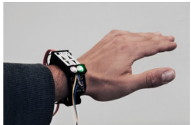
Das Armband misst Winkel und Beschleunigungen und steuert die Prothese an.
