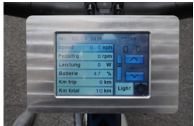
Das Display des E-Bikes zeigt die wichtigsten Fahrdaten an und dient auch zum Auswählen der verschiedenen Modi.
