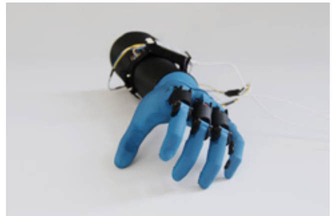
Die Hauptfunktion der Alltagshandprothese ist das Ergreifen von zylindrischen Objekten.
