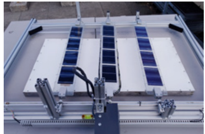
Der Miniaturmessstand BPRP stand im Zentrum der Bachelorarbeit. Die Absolventen untersuchten, wie er mit der grossen Anlage korreliert.
