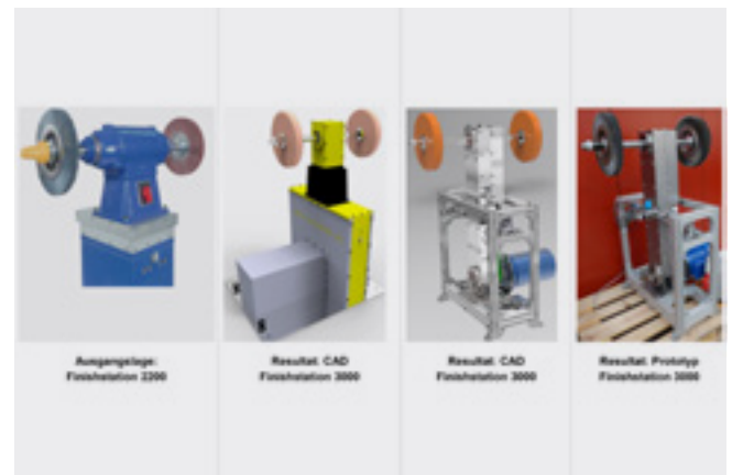
Die Bilderserie zeigt die Entwicklung von sehr einfachen Entgratvorrichtungen bis hin zur Finishstation, welche die beiden Absolventen entwickelt haben.
