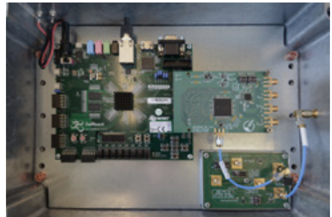
Masterabsolvent Thomas Henauer hat den gesamten GNSS-Empfänger selber konstruiert und gebaut.
