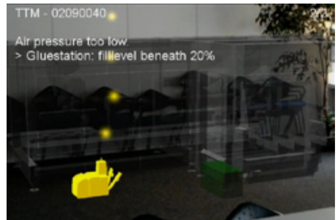
Die Software zeigt das fehlerhafte Bauteil in der Maschine an.
